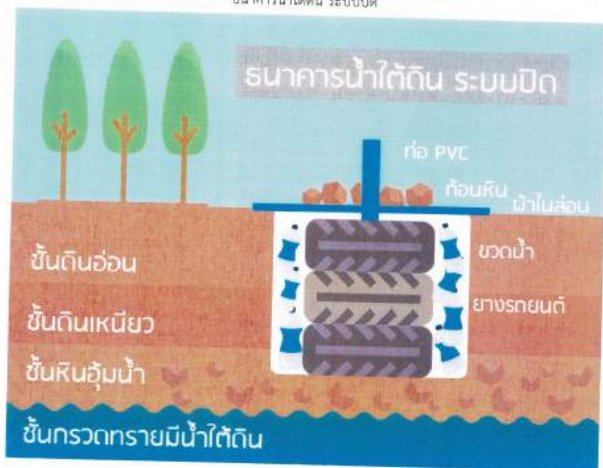
ธนาคารน้ำใต้ดิน ระบบปิด
